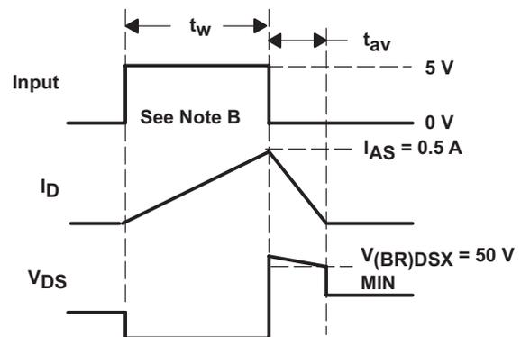
SINGLE-PULSE AVALANCHE ENERGY TEST CIRCUIT
